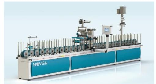
*Hot Melt, leader nel settore, consente di offrire soluzioni a 360° realizzate sulla base di ciascuna specifica richiesta. Gli impianti NMB sono idonei e funzionali al rivestimento di pannelli truciolari, MDF, metallo e pannelli/profili in PVC, ABS, PS con carte decorative CPL, PP, PVC, ABS-PMMA, PET”.*
